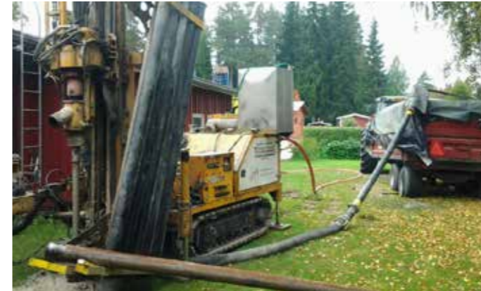
Kivituhkaa emme suosittele kerättäväksi suoraan traktorin peräkärriin. Kivituhka on niin painavaa, että kärry voi vioittua tai kaatua. Kärry pitäisi saada vesitiiviiksi ja tyhjennys voi olla haastavaa. Porausyrittäjä ei vastaa vahingoista peräkärriin purettaessa.
